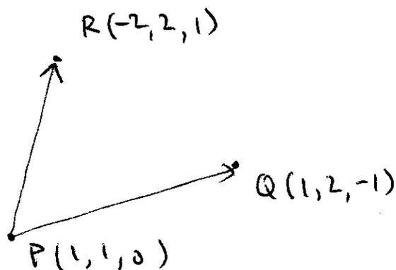
$$(i) \quad \vec{PR} \times \vec{PQ} = \begin{vmatrix} \vec{i} & \vec{j} & \vec{k} \\ -2 & 1 & 1 \\ 0 & 1 & -1 \end{vmatrix} = -2\vec{i} - 3\vec{j} - 3\vec{k}.$$
